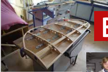
■ Statecznik w trakcie budowy na przyrządzie montażowym
