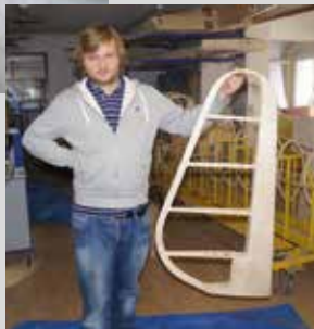
■ Statecznik w trakcie budowy na przyrządzie montażowym
