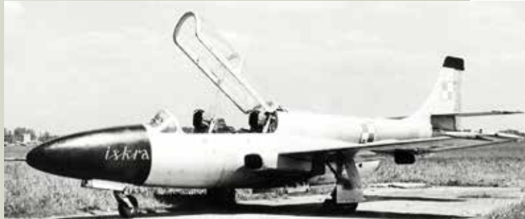
■ Pierwszy prototyp do badań w locie samolotu TS-11 Iskra
