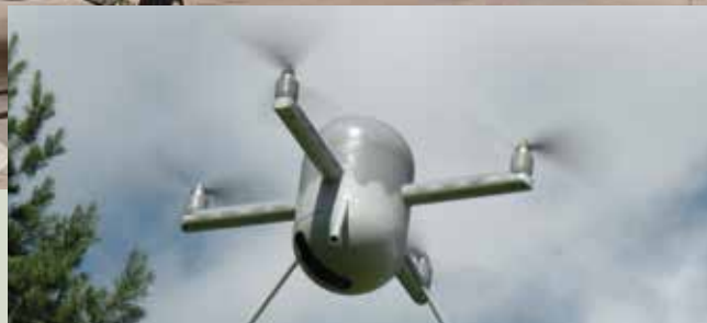
■ Kolibier – bezzałogowy statek powietrzny może poderwać się do lotu i wylądować bez potrzeby wykorzystywania pasa startowego lub wyrzutni, przeznaczony do pozyskiwania danych z obserwacji na terenach zurbanizowanych
