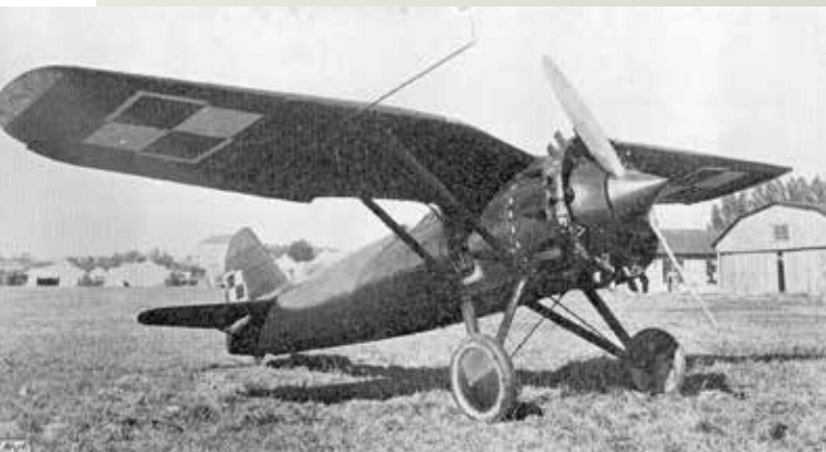
■ Prototyp samolotu myśliwskiego PZL P.7 podczas prób w 1931 r. Pod skrzydłem dzida z dyszą pomiarową
