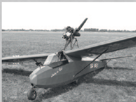
■ Czerwona Moto-Sroka K. Myśluka ze zmienionym podwoziem i silnikiem Rotax 503, nazwana „Lady in Red”
