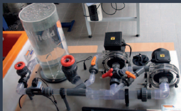
■ Stanowisko do wyznaczania charakterystyki układu dwóch pomp w połączeniu szeregowym lub równoległym
