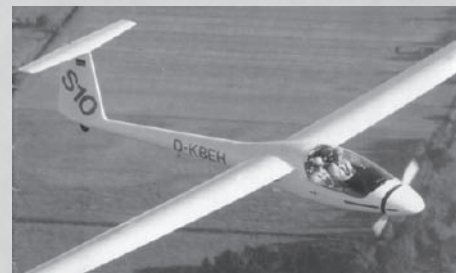
■ Niemiecki dwumiejscowy Stemme S 10 (1988 r.) z chowanym śmigłem, zbudowany w Polsce w serii 220 szt.
