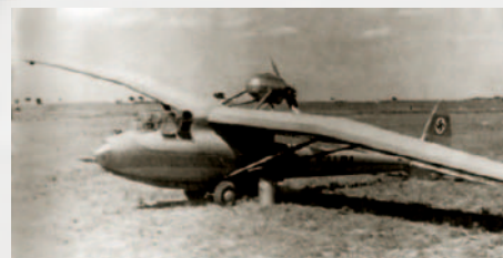
■ Zmotoryzowany niemiecki szybowiec M-Condor (1935 r.), 18 KM
